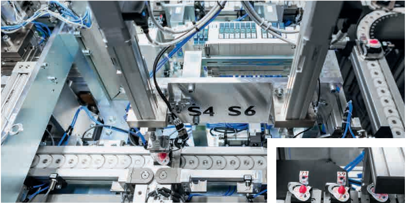
Ideal für einfache Anwendungen: Die Elektrozyylinder EPCO führen die Zugprüfung über 130 Newton durch.
